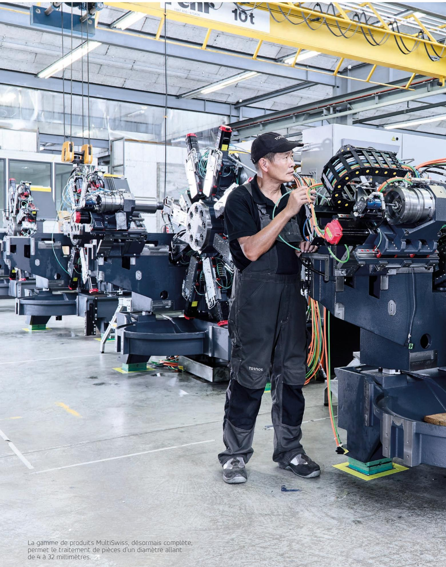
La gamme de produits MultiSwiss, désormais complète, permet le traitement de pièces d'un diamètre allant de 4 à 32 millimètres. ↗
