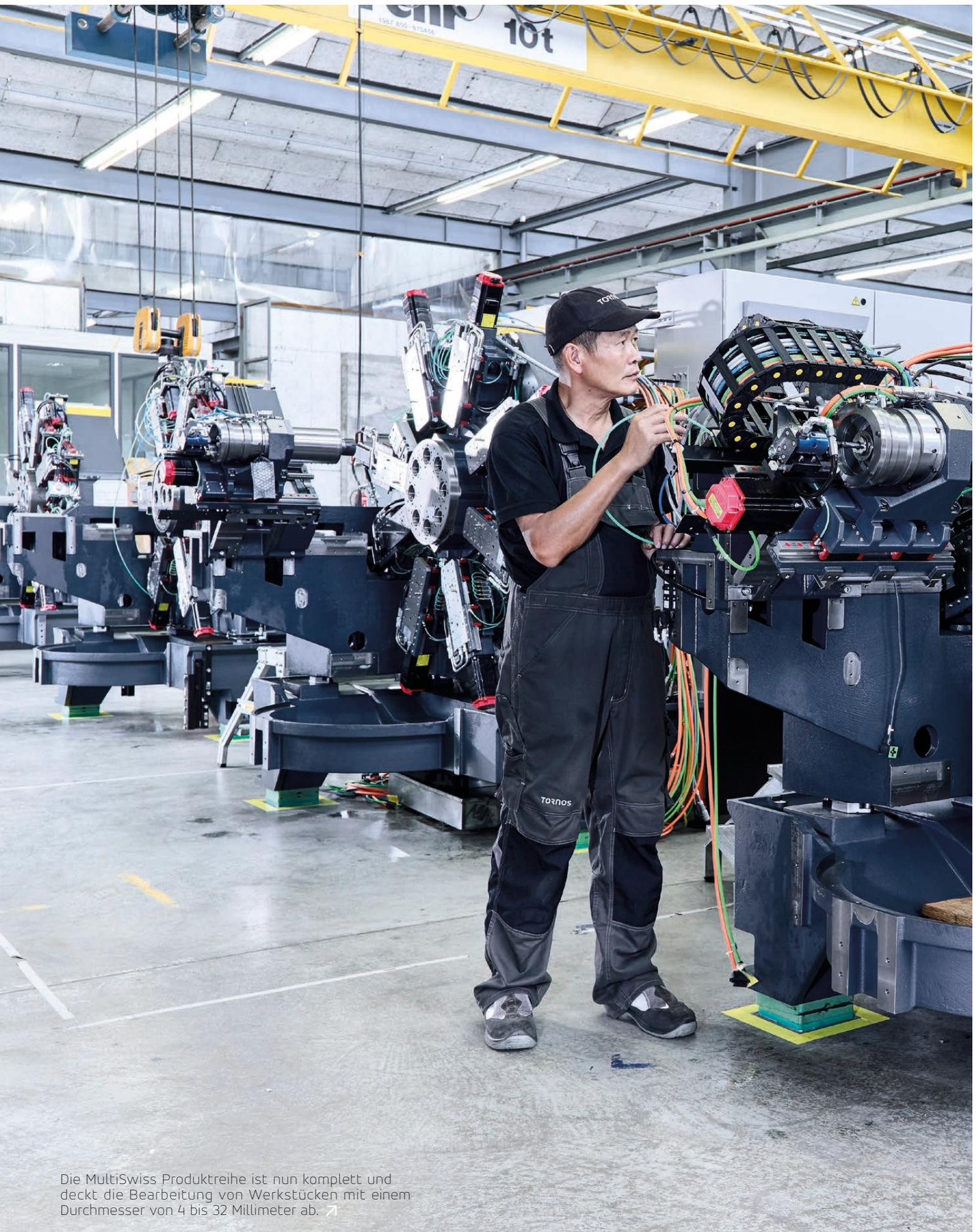
Die MultiSwiss Produktreihe ist nun komplett und deckt die Bearbeitung von Werkstücken mit einem Durchmesser von 4 bis 32 Millimeter ab. ↗
